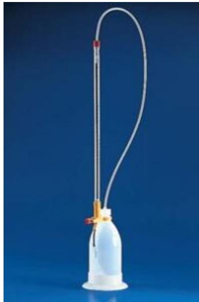
Caratteristiche: Automatiche, in plastica. Realizzate in Polimetilpentene (secondo le norme DIN 12.700, classe B) Bottiglia di alimentazione in PE con base in PE-LD Riempimento rapido premendo la bottiglia. Dotate di rubinetto di precisione per aggiunta goccia a goccia o per titolazione rapida. .
