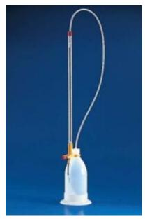
Burette di SCHILLINGMateriale: PE/PMPBurette di Schilling automatiche in plastica (secondo le norme din 12.700, classe B).Dotate di rubinetto di precisione per aggiunta goccia a goccia.Bottiglia in PE con base in PE-LD. .
