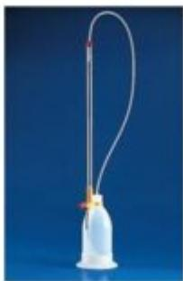
Caratteristiche principali: Tubo di riempimento in PVC, bottiglia e base in polietilene bassa densità, pulsante e pinza di fissaggio in polietilene. Riempimento rapido premendo la bottiglia; titolazione goccia a goccia agendo sulla vite micrometrica oppure titolazione rapida aprendo completamente la vite micrometrica e premendo il pulsante.
