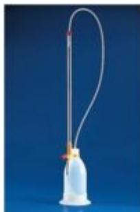
Caratteristiche principali: Tubo di riempimento in PVC, bottiglia e base in polietilene bassa densità, pulsante e pinza di fissaggio in polietilene. Riempimento rapido premendo la bottiglia; titolazione goccia a goccia agendo sulla vite micrometrica oppure titolazione rapida aprendo completamente la vite micrometrica e premendo il pulsante.
