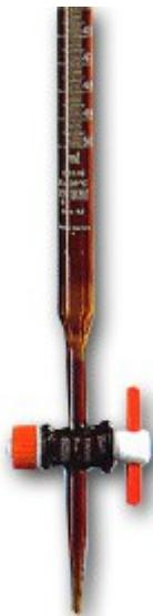
Caratteristiche principali: In vetro borosilicato resistente ai reagenti aggressivi. In vetro ambrato, graduazione bianca. ISO 385 (DIN 12700).
