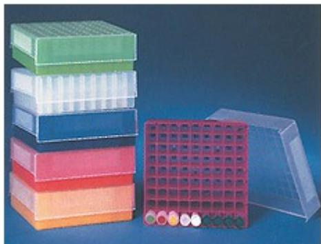
Caratteristiche principali: Scatole/Box di stoccaggio per microprovette e vials per criogenia da 1,5/2,0 ml in polipropilene resistenti, autoclavabili. Conservabili in freezer a -85 C°. Coperchio con griglia alfanumerica. Confezione da 5 pezzi colori assortiti: blu, verde, viola, giallo, arancione.
