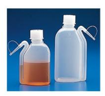
Bottiglie a spruzzetta modello integrale. Materiale: Polietilene Bottiglia a spruzzetta con tubo stampato integralmente assieme alla bottiglia evitando così perdite dovute a imperfetta tenuta fra tappo e tubo. Tappo normalizzato GL 32 intercambiabile con la serie di bottiglie 15801 – 1631. Forma ovale che facilita l'impugnatura e ne aumenta la stabilità.
