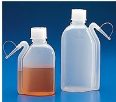
Bottiglie a spruzzetta modello integrale. Materiale: Polietilene. Bottiglia a spruzzetta con tubo stampato integralmente assieme alla bottiglia evitando così perdite dovute a imperfetta tenuta fra tappo e tubo. Tappo normalizzato GL 32 intercambiabile con la serie di bottiglie 15801 - 1631. Forma ovale che facilita l'impugnatura e ne aumenta la stabilità.
