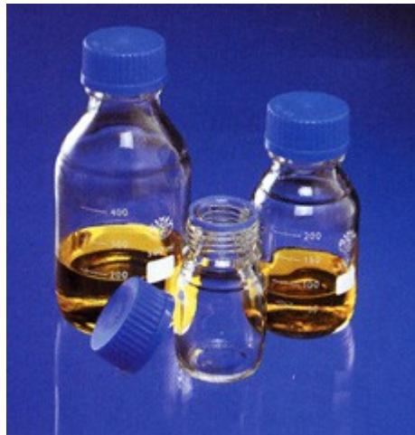
Caratteristiche principali: Graduato, con spazio bianco per scrittura. Viene fornito completo di tappo a vite ed anello salvagoccia in PP. Il tappo è resistente al calore fino a 140°C. Prodotto secondo gli standard ISO 4796-1, TP 1270.
