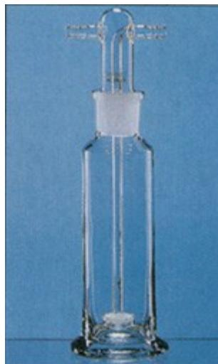
Caratteristiche tecniche: Vetro borosilicato a forma alta con cono smerigliato NS 29/32, tubi con strozzatura portagomma diametro esterno mm 8. Completa di tubo pescante con setto poroso P1. Conforme alle norme DIN 12596. .
