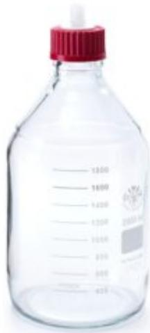
Bottiglia in vetro resistente per la raccolta sicura ed efficiente del solvente durante i processi di estrazione.
