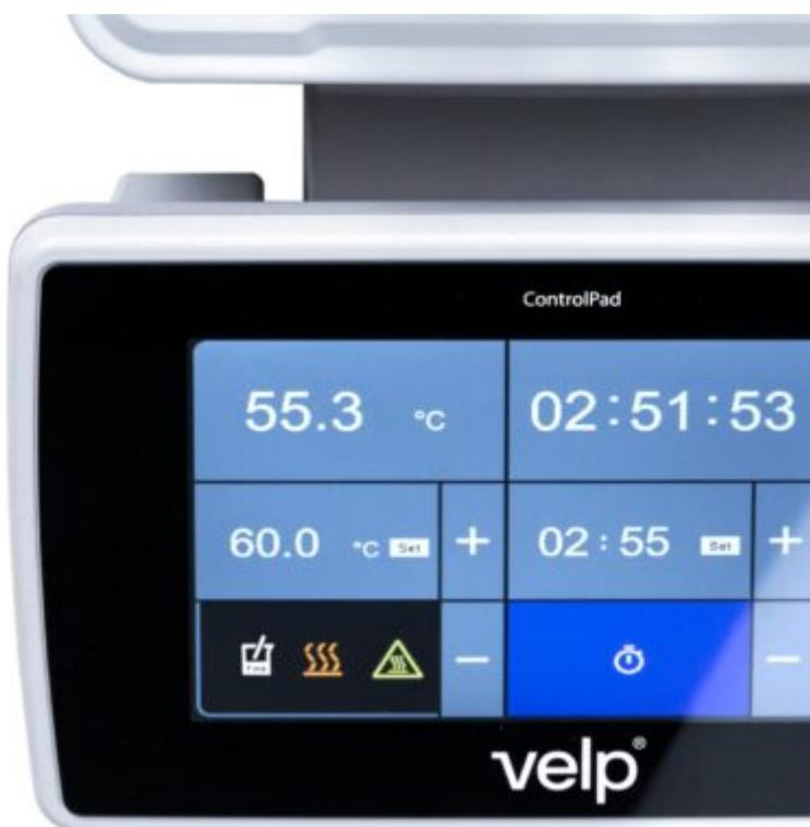
**Il funzionamento di ECODryBlock è semplice e intuitivo** grazie al ControlPad con schermo touch capacitivo da 7", dotato di una superficie in vetro resistente agli agenti chimici.
