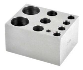
Gli accessori per i riscaldatori di blocchi OHAUS comprendono blocchi modulari per alloggiare qualunque tipo di campione. I blocchi modulari permettono alle provette di stare a stretto contatto con le pareti, consentendo un trasferimento di calore ottimale e la massima ritenzione del calore.
