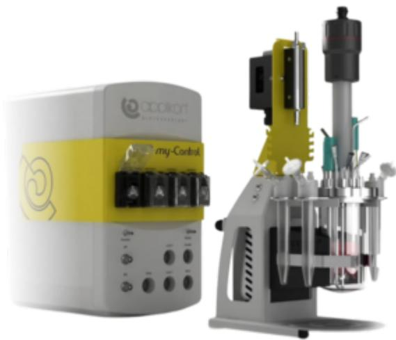
Il bundle MyControl Minibio è facile da configurare, non richiede abilità o strumenti speciali, è facile da usare. È disponibile con reattori in vetro con volume totale da 250 ml, 500 ml e 1000 ml per colture cellulari o per colture batteriche.
