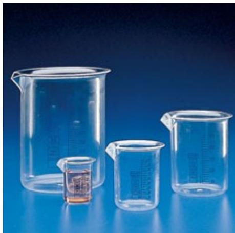
Caratteristiche: Realizzati in Polimetilpentene e secondo la norma ISO 7056 - 1981 (E) Perfettamente trasparenti, autoclavabili, resistono a temperature fino a 170°C per brevi periodi. La particolare forma del becco facilita lo svuotamento. Graduazione permanente, posseggono eccellente resistenza chimica. IDONEI AL CONTATTO ALIMENTARE. PMP (TPX?) .
