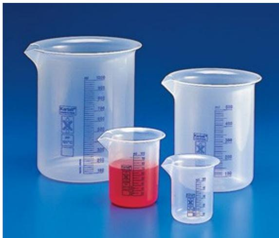
Caratteristiche: Realizzati in Polipropilene termoresistente e ad alta trasparenza, secondo la norma ISO 7056-1981 (E) Graduazione permanente, posseggono eccellente resistenza chimica. La particolare forma del becco, facilita lo svuotamento. Sono autoclavabili a 121°C per 20 minuti e resistono a 100°C durante l'uso continuato. IDONEI AL CONTATTO ALIMENTARE. .
