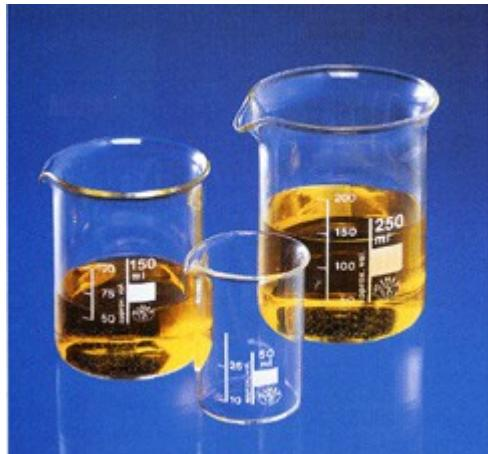
Caratteristiche principali: Vetro perfettamente trasparente. Temperatura massima di utilizzo 500°C. Elevata resistenza chimica. Prodotti secondo gli standard ISO 3819, DIN 12 331.
