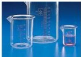
Caratteristiche: Realizzati in Polimetilpentene e secondo la norma ISO 7056 - 1981 (E) Perfettamente trasparenti, autoclavabili, resistono a temperature fino a 170°C per brevi periodi. Hanno forma cilindrica, con fondo piano. La graduazione permanente è stampata in rilievo e di facile lettura. La particolare forma del becco, facilita lo svuotamento. Posseggono eccellente resistenza chimica e sono dotati di buona inerzia chimica. IDONEI AL CONTATTO ALIMENTARE. PMP (TPX?) .
