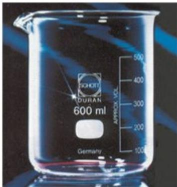
Caratteristiche principali: Offre un'alta resistenza agli sbalzi di temperatura in quanto possiede un coefficiente di dilatazione lineare molto basso. La graduazione è in ml. Spessore uniforme, vetro perfettamente trasparente. Prodotto secondo gli standard DIN 12331, ISO 3819.
