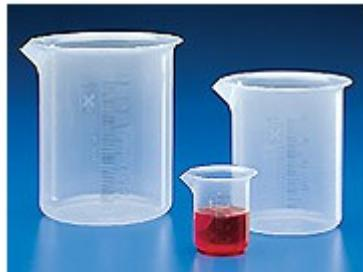
**Caratteristiche:** Realizzati in Polipropilene termoresistente e ad alta trasparenza, secondo la norma ISO 7056 - 1981 (E) Hanno forma cilindrica, con fondo piano. La graduazione permanente è stampata in rilievo e di facile lettura. La particolare foma del becco, facilita lo svuotamento. Posseggono eccellente resistenza chimica e sono dotati di buona inerzia chimica. Sono autoclavabili a 121°C per 20 minuti e resistono a 100°C per uso continuato. IDONEI AL CONTATTO ALIMENTARE. .
