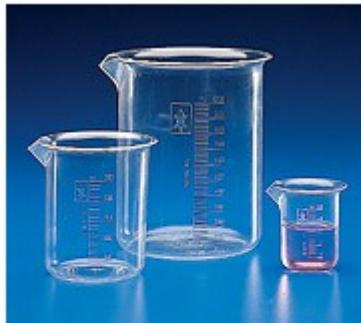
**Caratteristiche:** Realizzati in Polimetilpentene e secondo la norma ISO 7056 - 1981 (E) Perfettamente trasparenti, autoclavabili, resistono a temperature fino a 170°C per brevi periodi. Hanno forma cilindrica, con fondo piano. La graduazione permanente è stampata in rilievo e di facile lettura. La particolare forma del becco, facilita lo svuotamento. Posseggono eccellente resistenza chimica e sono dotati di buona inerzia chimica. IDONEI AL CONTATTO ALIMENTARE. PMP (TPX?) .
