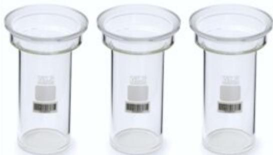
Piccolo bicchiere di estrazione progettato per l'analisi di campioni ad alto contenuto di grassi. Consente un'estrazione efficiente utilizzando piccole quantità di campione, fornendo risultati affidabili e costanti per applicazioni che richiedono estrazioni precise e controllate.
