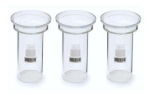
Piccolo bicchiere di estrazione progettato per l'analisi di campioni ad alto contenuto di grassi. Consente un'estrazione efficiente utilizzando piccole quantità di campione, fornendo risultati affidabili e costanti per applicazioni che richiedono estrazioni precise e controllate.
