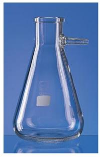
Caratteristiche principali: Pareti spesse per una migliore resistenza al vuoto. Connettore ad oliva per tubi di raccordo flessibile con diametro interno 9 mm. Conformi alla norma ISO DIN 6556. .
