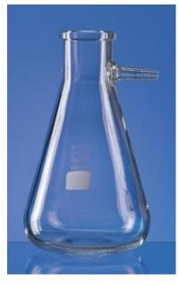
Caratteristiche principali: Graduazione ed etichetta di colore bianco per la scrittura. Autoclavabili. Conformi alla norma ISO DIN 6556. .
