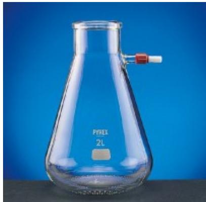
Caratteristiche principali: Pareti spesse per una migliore resistenza al vuoto. Connettore a vite e giunto di collegamento per raccordo ad un tubo di diametro interno 9 mm. Conformi alla norma ISO 6556 e DIN 12476. .
