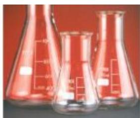
Caratteristiche principali: Vetro borosilicato Pyrex® o Duran®, perfettamente trasparente, spessore uniforme con notevole resistenza agli sbalzi termici. Graduazione approx ed imboccatura svasata con bordo salvagoccia. Secondo DIN/ISO 24450.
