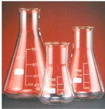
Caratteristiche principali: Vetro borosilicato Pyrex® o Duran®, perfettamente trasparente, spessore uniforme con notevole resistenza agli sbalzi termici. Graduazione approx ed imboccatura svasata con bordo salvagoccia. Secondo DIN/ISO 24450.
