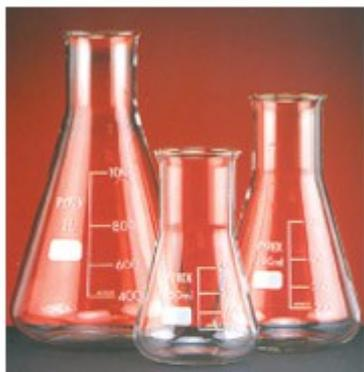
Caratteristiche principali: Vetro borosilicato Pyrex® o Duran®, perfettamente trasparente, spessore uniforme con notevole resistenza agli sbalzi termici. Graduazione approx ed imboccatura svasata con bordo salvagoccia. Secondo DIN/ISO 24450.
