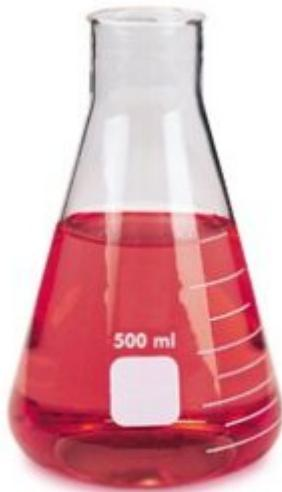
Caratteristiche principali: Graduazione approssimativa ed imboccatura svasata con bordo salvagoccia. Vetro perfettamente trasparente, spessore uniforme con notevole resistenza agli sbalzi termici. Secondo DIN 12380/ISO 1773.
