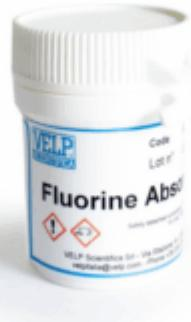
Progettato per proteggere il reattore dell'analizzatore elementare EMA 502 durante l'analisi di campioni contenenti fluoro, prolungandone la durata senza influenzare l'attività del catalizzatore.
