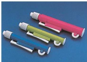
Caratteristiche: Aspiratori manuali per pipette, in polipropilene. Adatti per tutti i tipi di pipette, sia in vetro che in plastica. Aspirazione e dosaggio tramite manopola girevole. Completa fuoriuscita del liquido mediante pressione della levetta.
