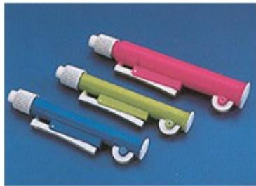
**Caratteristiche:** Aspiratori manuali per pipette, in polipropilene. Adatti per tutti i tipi di pipette, sia in vetro che in plastica. Aspirazione e dosaggio tramite manopola girevole. Completa fuoriuscita del liquido mediante pressione della levetta.
