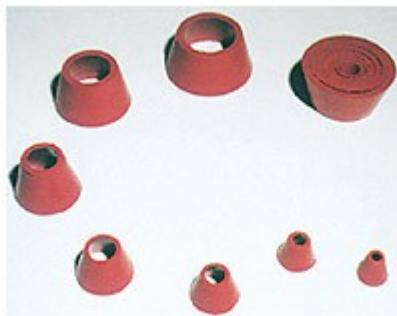
Sostegni adattatori per filtrazione in gomma rossa. Posti su un matraccio per filtrazione sostengono imbuti, crogioli di Gooch, tubi filtranti. Serie completa di 7 anelli
