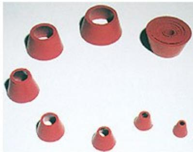
Sostegni adattatori per filtrazione in gomma rossa. Posti su un matraccio per filtrazione sostengono imbuti, crogioli di Gooch, tubi filtranti.
