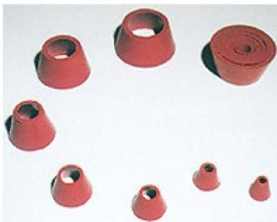
Sostegni adattatori per filtrazione in gomma rossa. Posti su un matraccio per filtrazione sostengono imbuti, crogioli di Gooch, tubi filtranti. Disponibili singolarmente o come serie completa.
