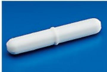
**Caratteristiche:** Le superfici angolate creano elevata turbolenza anche a bassa velocità. Ideali per contenitori con fondo irregolare. L'anello di rotazione riduce la superficie di contatto e favorisce il posizionamento ottimale dell'ancoretta. Posseggono magneti interni in Alnico V che conferisce loro caratteristiche di elevata durata e potenza. Questi magneti sono incapsulati in involucri in PTFE di prima scelta. IDONEE AL CONTATTO ALIMENTARE.
