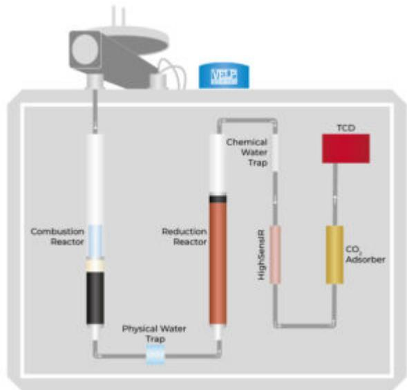
Il campione viene introdotto nel reattore a **temperature > 1000°C**, dove avviene la combustione. L'acqua viene eliminata tramite:
