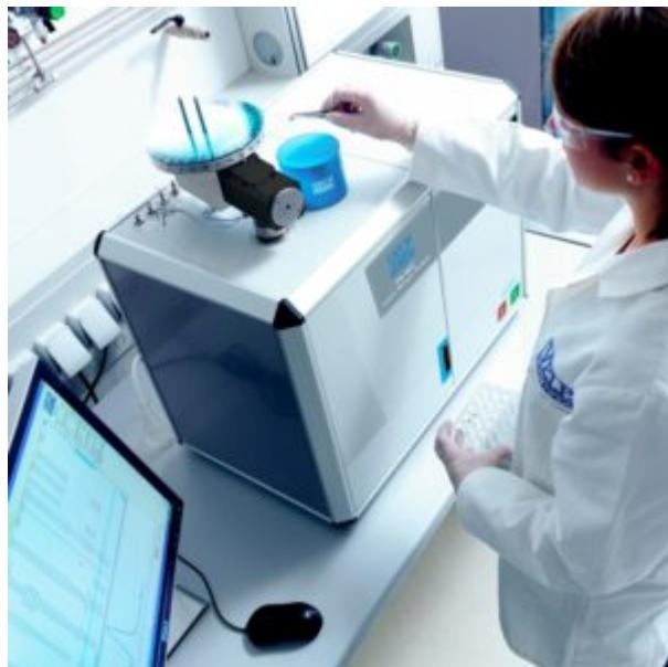
Il **CN 802** è un analizzatore a combustione robusto e versatile, progettato per operare in conformità con i metodi ufficiali per la determinazione di carbonio e azoto in diversi settori industriali: ambiente, agricoltura, chimica e alimentare. Gestito tramite il **software CNSoft™**, fornisce risultati automatici e in soli 5 minuti dei seguenti parametri:
