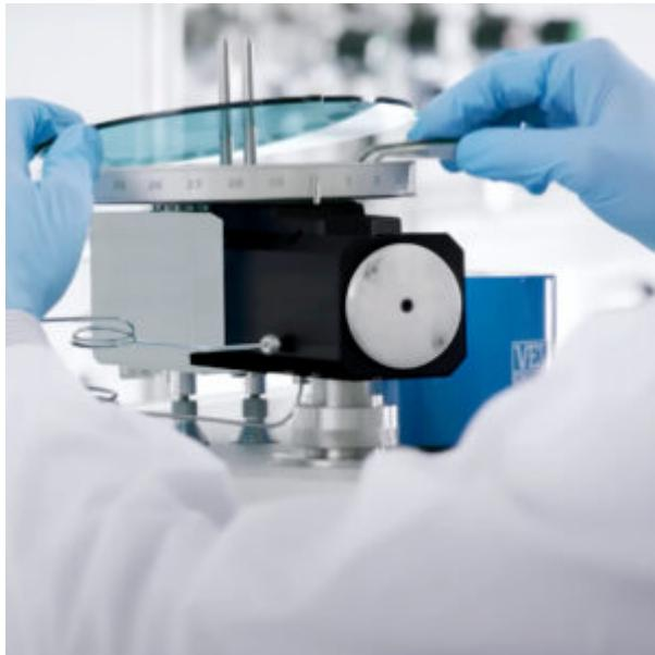
Il CN 802 permette l'analisi di una vasta gamma di **campioni solidi, semisolidi e liquidi**. Gestisce pesi e volumi elevati, sia per campioni non omogenei che a basse concentrazioni, garantendo risultati **precisi e riproducibili**.
