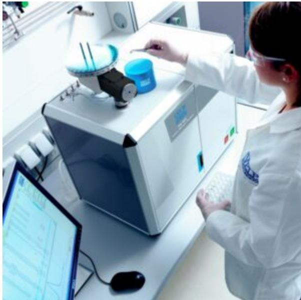
Il **CN 802** è un analizzatore a combustione robusto e versatile, progettato per operare in conformità con i metodi ufficiali per la determinazione di carbonio e azoto in diversi settori industriali: ambiente, agricoltura, chimica e alimentare.
