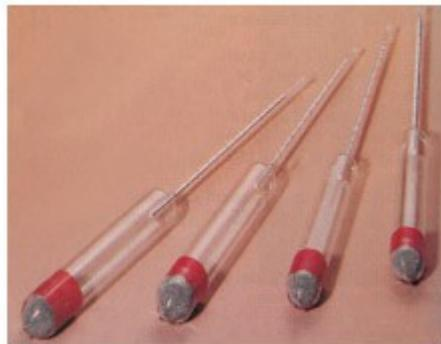
Alcolometro classe II precisione divisione scala :  $\pm 0,1$  lunghezza :400mm taratura : 20°C con termometro 5÷25:0,2°C con liquido speciale rosso o blu adatto per la calibrazione
