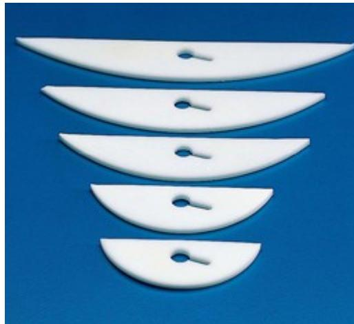
Caratteristiche: Hanno una forma particolare che permette un'efficace agitazione anche sul fondo del pallone e sono dotati di chiavetta centrale con fori da 9 mm. Lo snodo a chiavetta permette l'introduzione dell'agitatore attraverso il collo del pallone.
