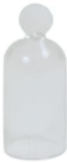
La campana antischizzo VELP è un accessorio fondamentale, progettato per ridurre gli schizzi e le perdite da evaporazione durante i processi di riscaldamento in laboratorio.
