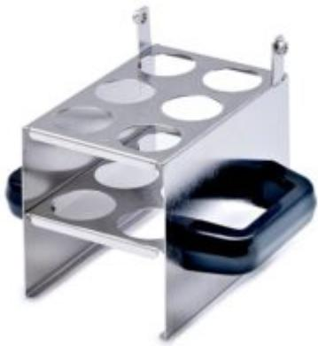
Permette la manipolazione dei provettoni dall'unità di digestione in modo semplice e in completa sicurezza.
