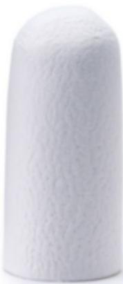
Ditali di cellulosa di dimensioni standard, progettati per una filtrazione efficiente e affidabile durante i processi di estrazione a solventi.
