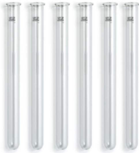
Provettini per analisi Micro-Kjeldahl su campioni omogenei di piccole dimensioni e ad alto contenuto di azoto/proteine: 10-30 mg di campione solido, 1-3 mL di campione liquido.
