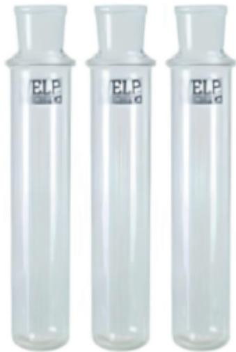
Provettoni in vetro per l'analisi del COD (Domanda Chimica di Ossigeno) nei laboratori che trattano campioni acquosi e acque reflue.
