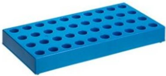
Rack per provette per criogenia CRYO.S™ in policarbonato.
