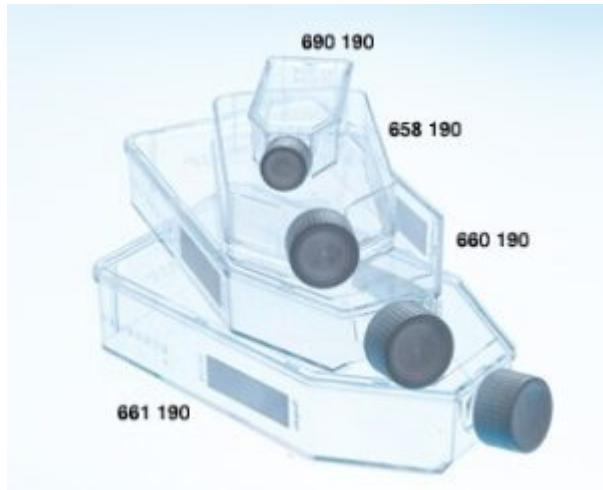
Fiasche per colture in sospensione, realizzate in polistirene, sterili, Greiner Bio One serie CELLSTAR®, con collo inclinato e tappo standard. Caratteristiche: Superficie idrofobica ideale per le cellule in sospensione. Esenti da DNase, RNase e DNA umano. Apriogene, non cito-tossiche. Tappo a vite in politene di colore bianco. Collo inclinato. Area di scrittura per le fiasche da 550 e 650 ml. Graduate e impilabili. Confezioni sterili e di facile utilizzo.
