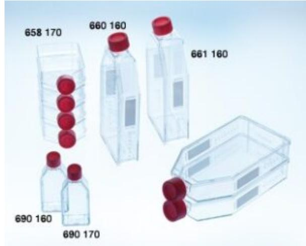
Fiasche per colture cellulari in adesione, realizzate in polistirene, sterili, Greiner Bio One serieCELLSTAR®, con collo inclinato e tappo standard. Caratteristiche: Trattamento superficiale con TC per migliorare l'adesione cellulare. Esenti da DNase, RNase e DNA umano. Apriogene, non cito-tossiche. Tappo a vite in politene di colore rosso, con indicatore della posizione di ventilazione. Collo inclinato. Area di scrittura. Confezione sterile e di facile utilizzo.
