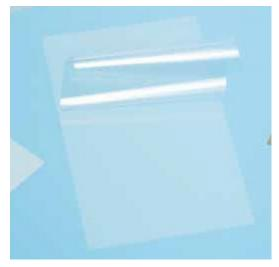
Caratteristiche: Pellicola sigillante adesiva trasparente con adesivo acrilato. Costituita da un film in polipropilene con spessore di  $51~\mu m$  a bassissima auto fluorescenza, in particolare nell'intervallo di lunghezze d'onda delle metodiche di RT-PCR. L'adesivo è protetto da un foglio in poliestere. Ottima alternativa ai sistemi termosaldanti ed essendo pensata come dispositivo mono-uso riducano notevolmente le contaminazioni incrociate. Non sterile. Confezione da  $100~\rm pezzi$ .
