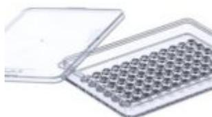
Coperchi in polistirene per la protezione da contaminazioni e/od evaporazione durante l'utilizzo di : Esente DNasi rilevabili, RNasi, DNA umano Apirogeni Offrono protezione contro la contaminazione e l'evaporazione durante la conservazione del campione e la coltivazione cellulare Sono utilizzati principalmente per micropiastre a 96 pozzetti .
