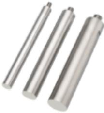
Sonda extender "Half Wave" con diametro di 13 mm e lunghezza 127 mm, in lega Ti-6Al-4V. Si avvita alla sonda 630-0220. Raccomandata per contenitori alti.
